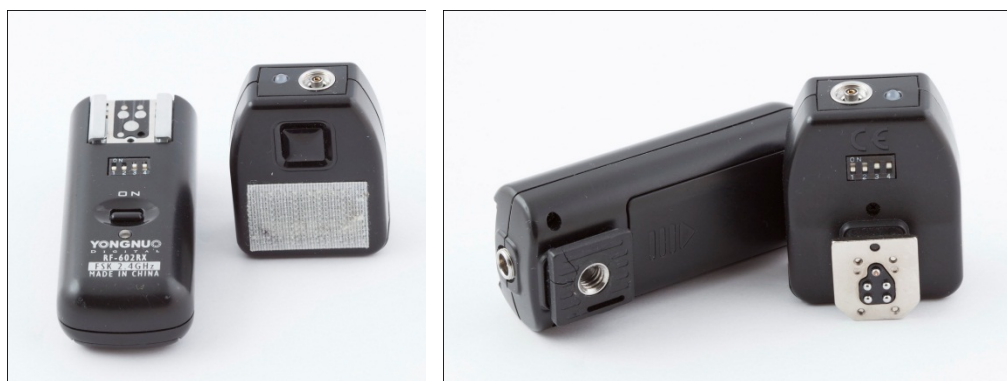
Le transmetteur et le récepteur Yongnuo RF-602
